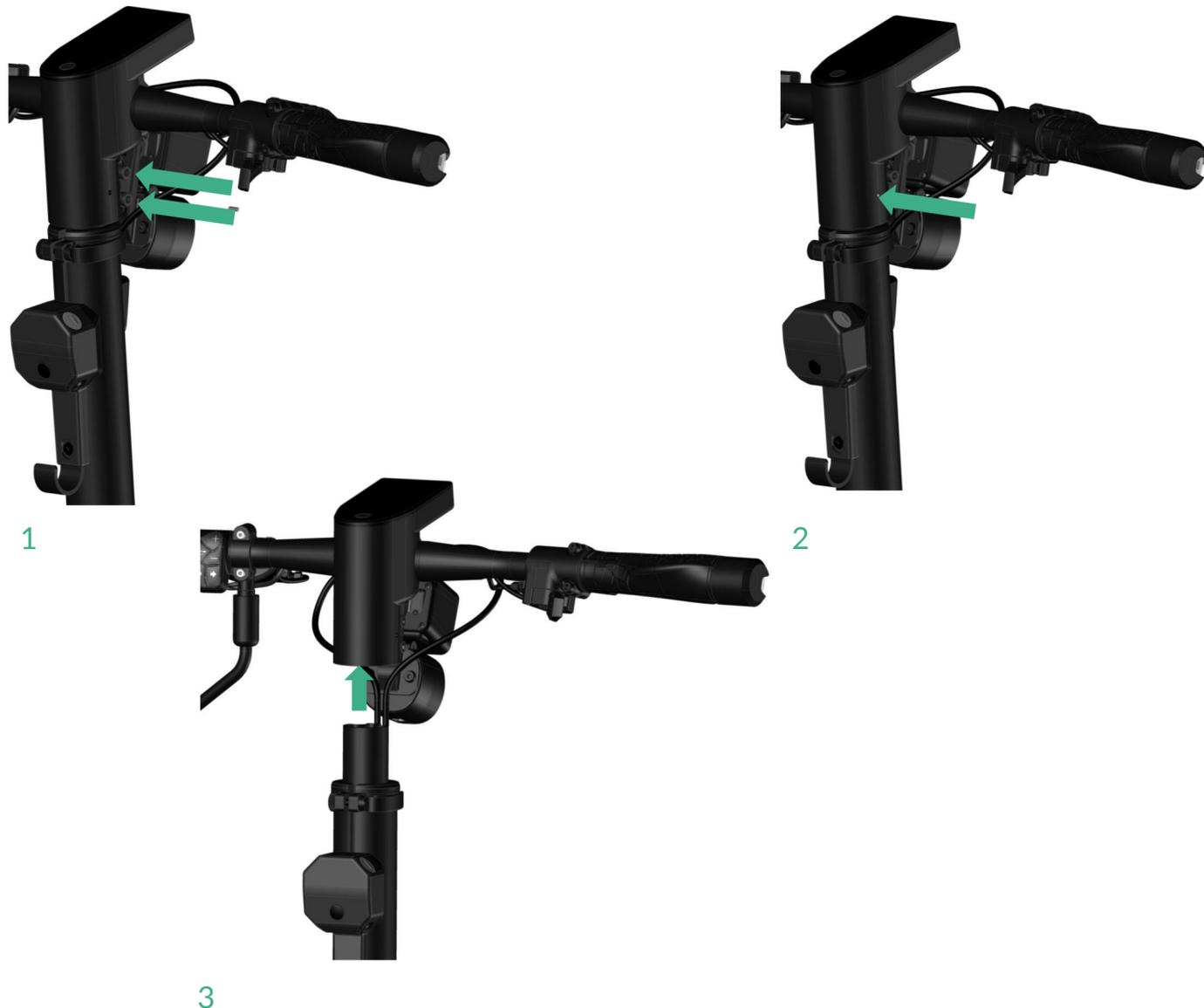
1. Um einen Displaytausch durchzuführen, muss zunächst der Lenkkopf vom Lenkrohr gelöst werden. Hierfür löse die beiden Schrauben (H 4), mit denen auch die Lampenhalterung angeschraubt ist. Es reicht aus, wenn du diese Schrauben nur löst (siehe Bild 1).
