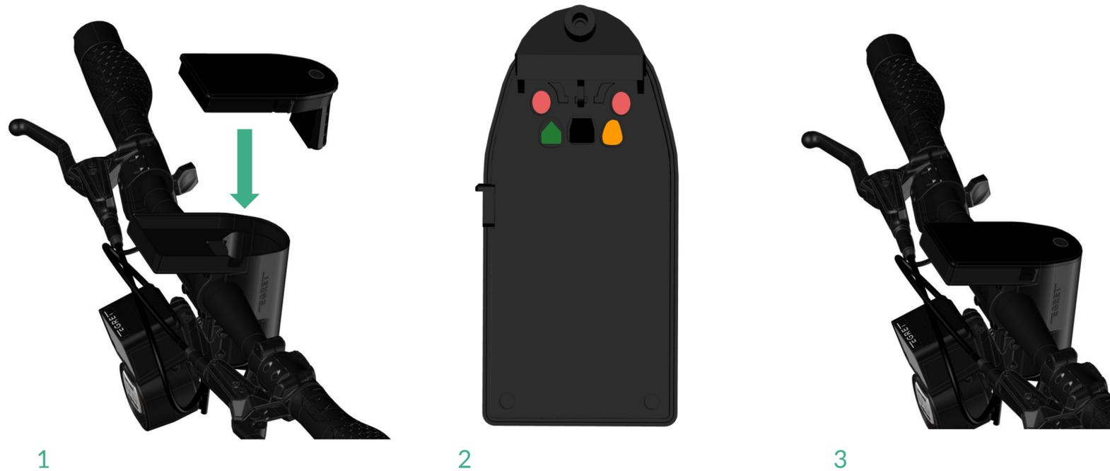
1. Um das neue Display einzubauen, müssen zunächst alle Stecker wieder korrekt angeschlossen werden (siehe Bild 2):
