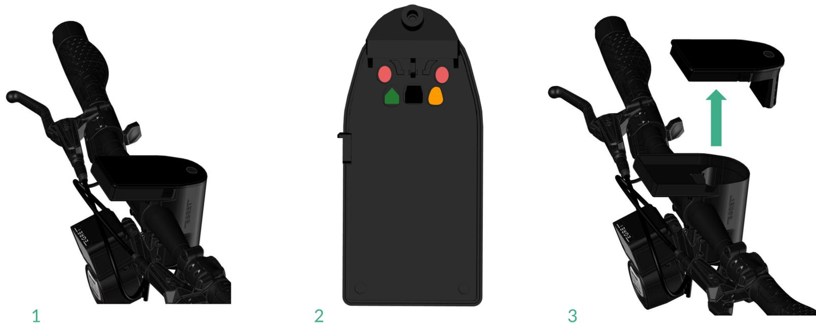
1. Du kannst jetzt das Display vorsichtig vom Lenkkopf abheben. Trenne dafür zunächst alle Steckverbindungen (siehe Bild 2):
